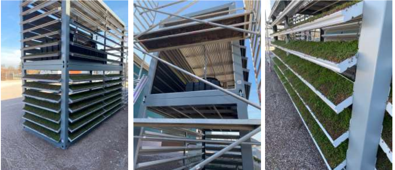
Abb. 2 – 4 Versuche mit der Systembegrünung CityLam in Wiegendorf
